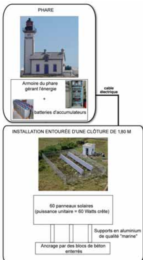
[1] Schéma du fonctionnement des panneaux solaires de l'île aux Moutons.
