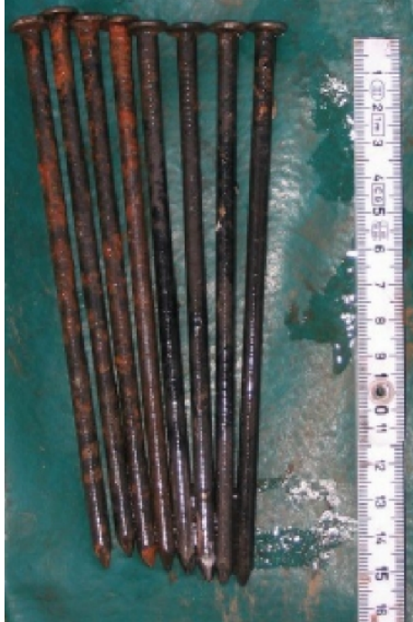
Figure 13. Clous enfonc s, pendant 3 mois, dans des s diments oxyg n s (les 4 clous de gauche) et dans des s diments pas oxyg n s (4 clous de droite).
