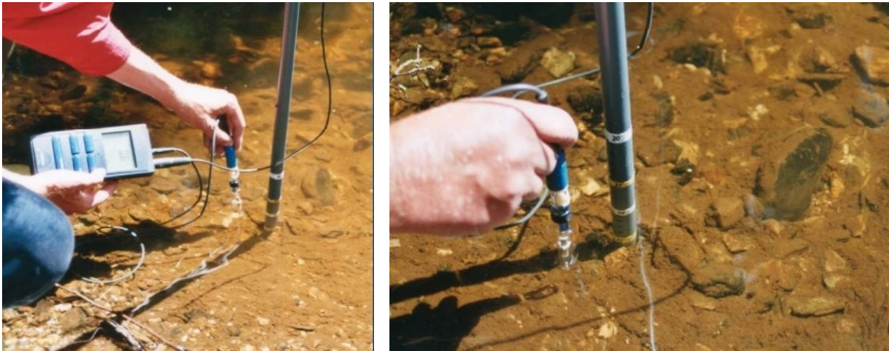
Figure 7. Mesure du potentiel red-ox à différentes profondeurs (J. Geist)
