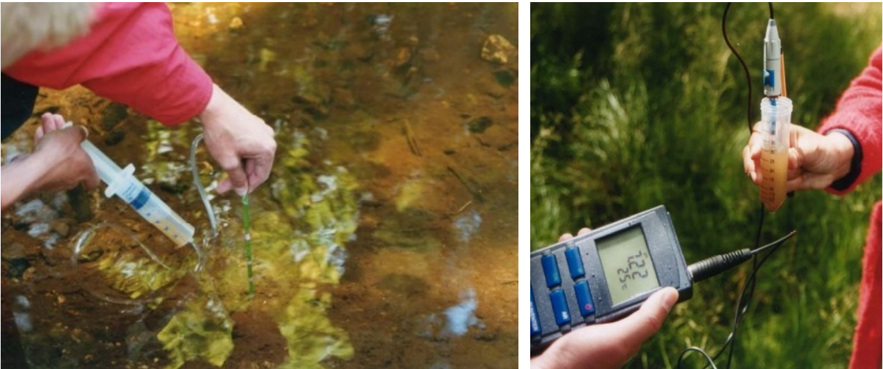
Figure 9. Mesure de la qualité de l'eau interstitielle (J. Geist)
