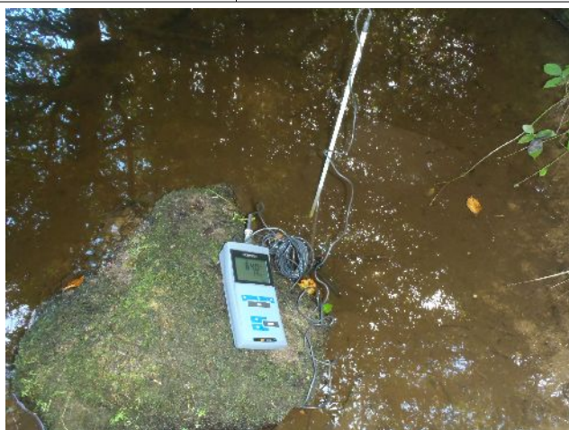
Mesure du potentiel red-ox
