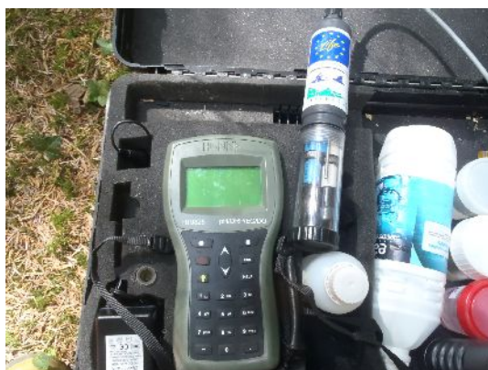
Appareil Hanna HI 9828 permettant de mesurer le pH, la conductivité, l'oxygène dissous et la température
