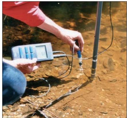
[3] Mesure du potentiel red-ox à différentes profondeurs
