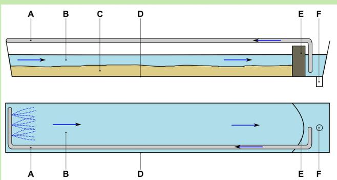
Fig. 1. Rearing tank (A : returning pipe supplied by a pump ; B : 36 µm filtered water ; C : sediment ; D : tank ; E : grid ; F : purge).
